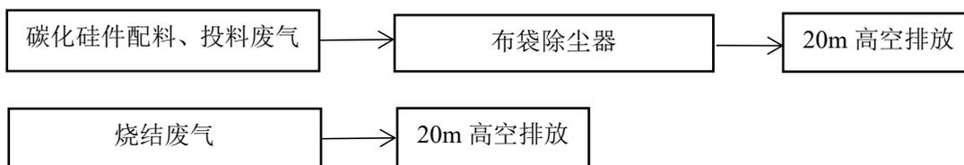
图 3-2 实际废气处理流程图
