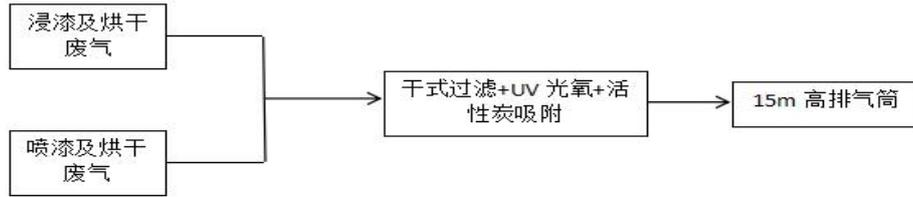
图4-2 厂区废气处理流程图
