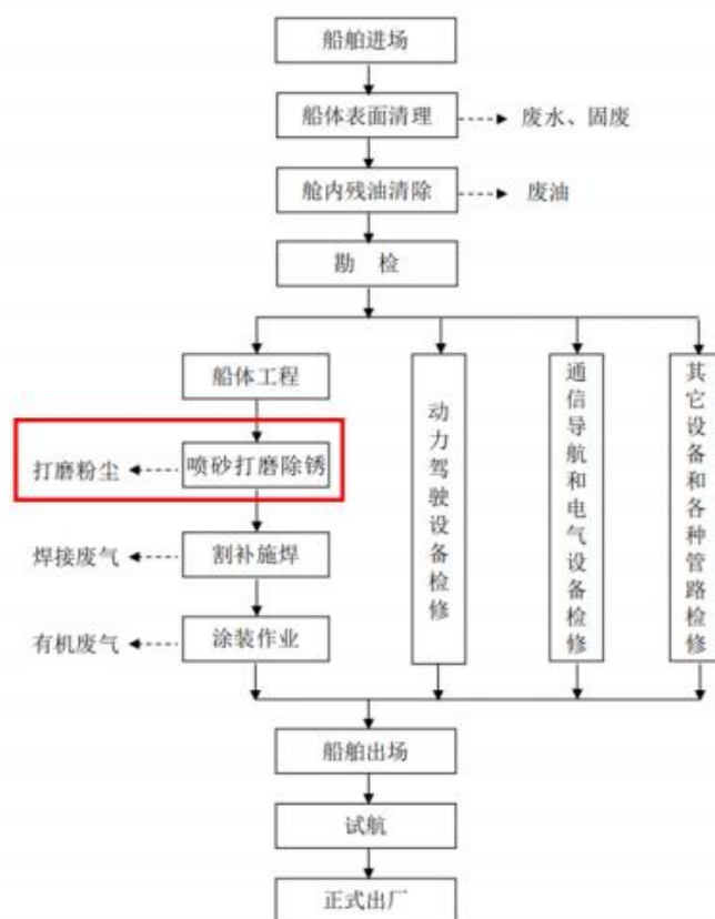
图 2.1-1 修船工艺流程图
