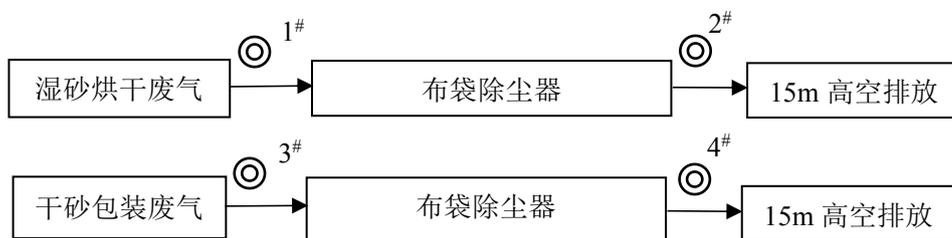
图 6-2 有组织废气采样点位示意图
